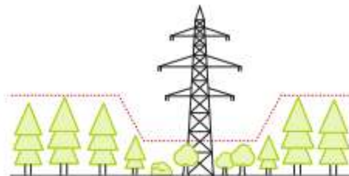
Ausholungen und Schneiden bei Freileitungen
