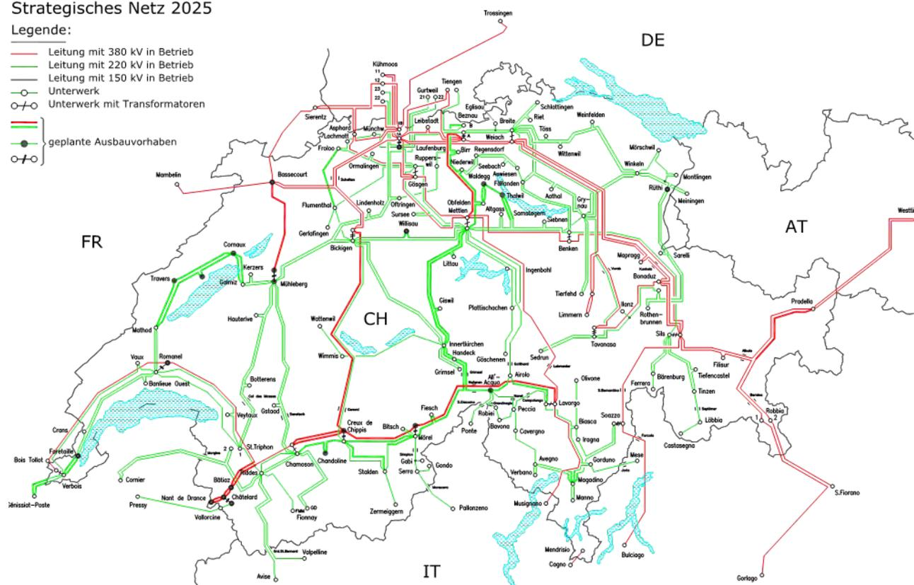
Abb. 2 Höchstspannungsnetz der Schweiz (Stand 2016).
