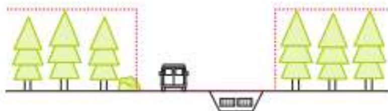
Ausholungen und Schneisen bei Erdkabeln
