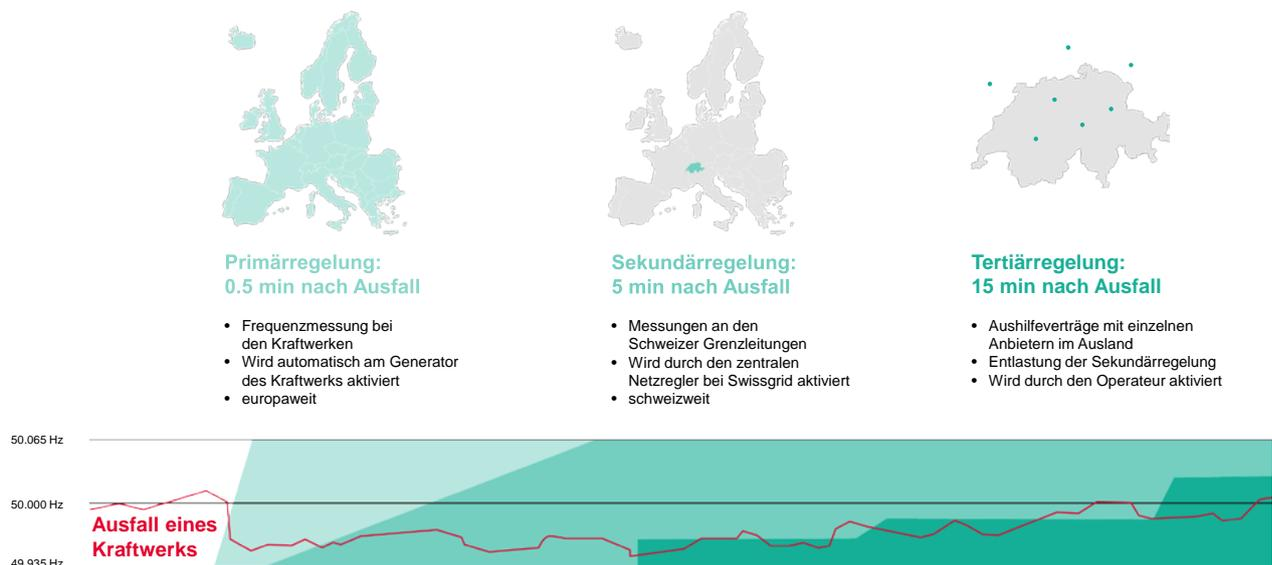
Abbildung 1: Beispiel eines Kraftwerksausfalls.
