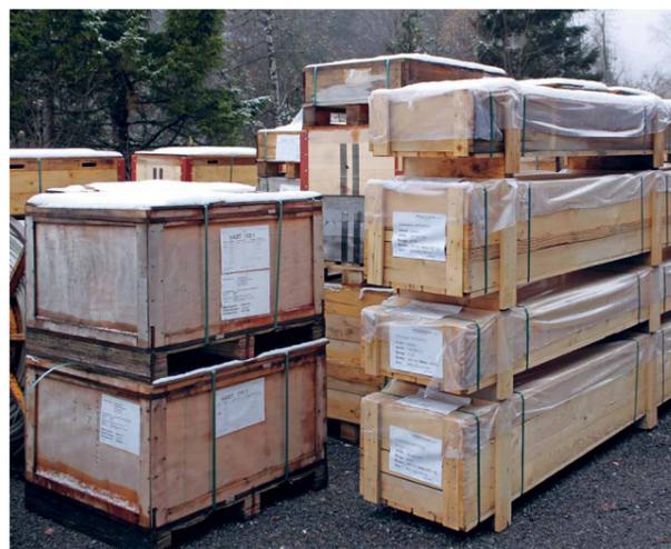
**Prestation précise avec une logistique bien pensée:** PFISTERER livre les armatures de chaîne (à gauche) et les isolateurs 380 kV (à droite) emballés ensemble pour chaque pylône – conformément à l'exigence formulée par Swissgrid pour un approvisionnement du matériel facilitant le montage.
